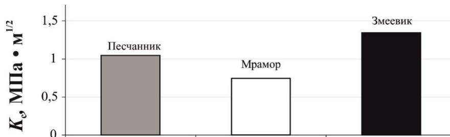
Рисунок 2. Значения вязкости разрушения  $K_c$  для образцов различных горных пород
