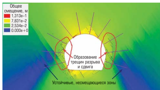
Рис. 3. Трещинообразование вокруг выработки, пройденной в массиве с преобладающими вертикальными напряжениями
